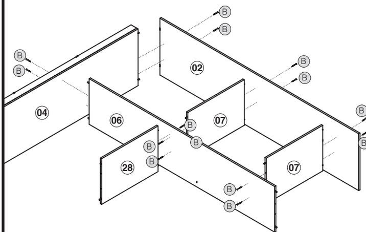
HORA DE COMEÇAR A UNIR AS PEÇAS QUE FORAM PREPARADAS! VIRE O CONJUNTO FORMADO PELA BASE (4) E PELOS RODAPÉS, COMO MOSTRA A FIGURA. ADICIONE A LATERAL ESQUERDA (02), A DIVISÓRIA ESQUERDA (06) E AS PRATELEIRAS (07).
